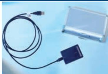
Le NONIUS est équipé d'un câble USB et livré avec le logiciel associé dans une mallette de transport compacte. Il peut être branché à n'importe quel ordinateur portable ou Tablette PC avec un système d'exploitation Windows OS.
