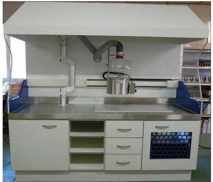
Atelier de moulage avec pot de fusion sur rails, hotte aspirante, plateau refroidisseur et rangement
